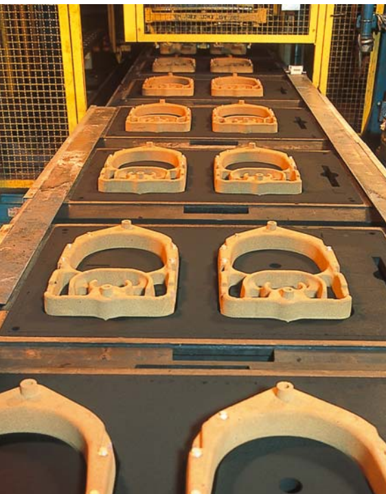
Der zwischen den Formkästen eingesetzte Kern wird durch aufgeklebte Stützen in Position gehalten.
