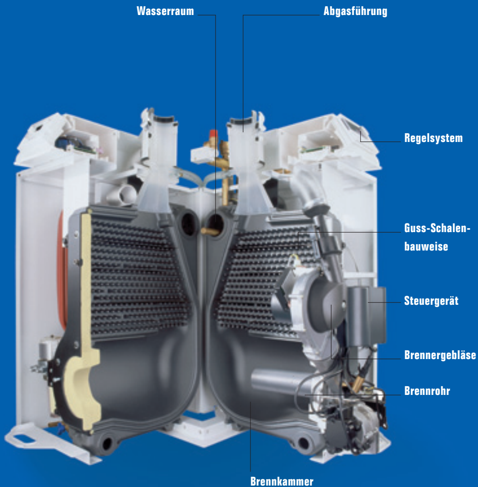
Aufbau eines modernen Öl-Gussheizkessels mit Blaubrenner (Schnittdarstellung des Öl-Kompaktheizkessels Logano plus GB135)
