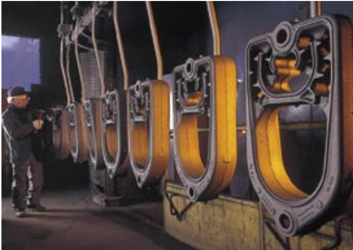
Wie die Perlen auf einer Schnur sind die Kesselglieder aufgehängt. Die abgekühlten und geputzten Gussteile werden dann zum nächsten Bearbeitungspunkt befördert.
