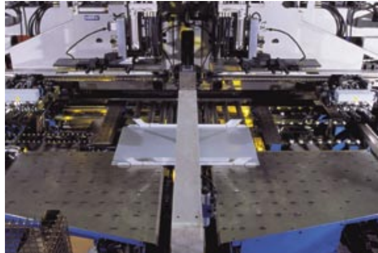
In der Blechbearbeitung sind flexible Fertigungssysteme am Werk. Computergesteuerte Maschinen schneiden das Material zu, stanzen die Löcher und geben der Verkleidung ihr „Gesicht“.
