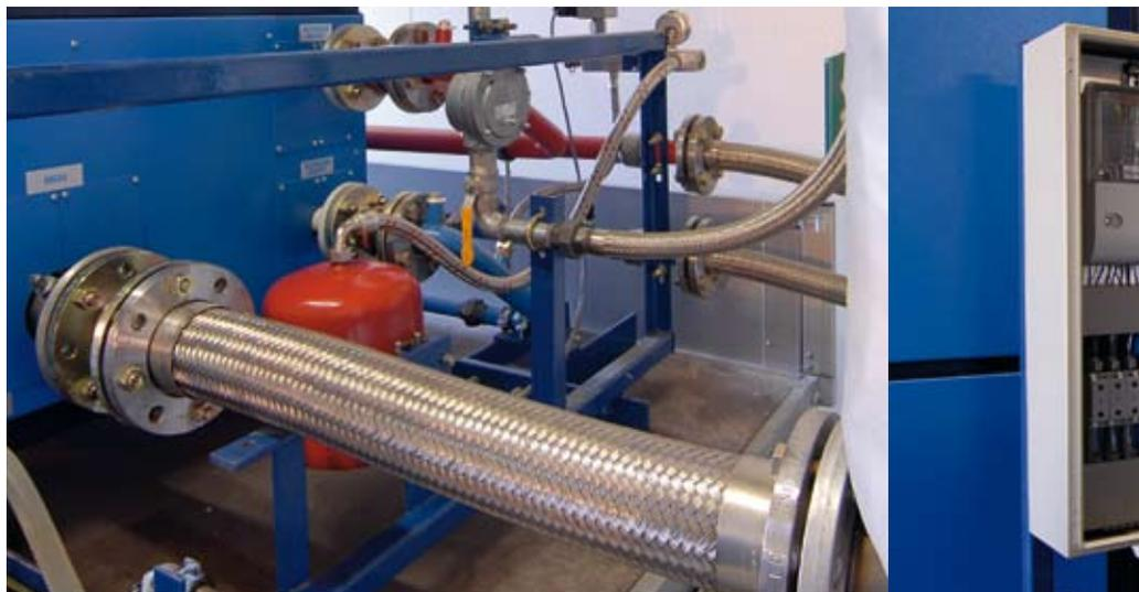
Die Verbindung mit den Anlagenkomponenten für Strom, Gas, Abgas und Heizkessel erfolgt über flexible Schläuche.
