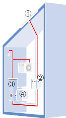
Ein eingespieltes Team besteht aus Sonnenkollektoren (1), Komplettstation (2), Warmwasser-Speicher (3) und Öl- oder Gasheizkessel (4).
