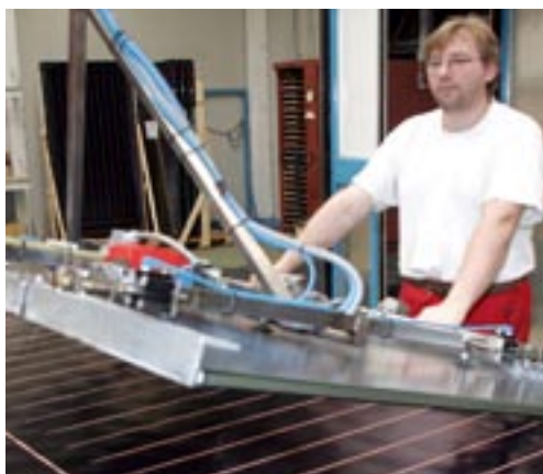
Die Tafel in der Montagehalle zeigt immer den aktuellen Stand der Produktion an (oben). Absorber und Glasscheibe werden mit dem Rahmen zu einer Einheit verbunden.
