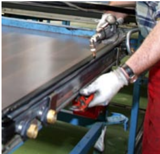
Mit einem Edelstahl-/Butyl-Dichtungssystem werden die Sonnenkollektoren Logasol SKS 3.0 dauerhaft und hermetisch abgedichtet.
