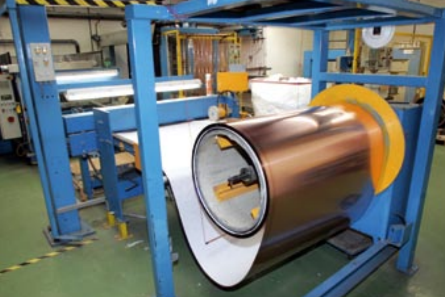
Auf großen Rollen wird das Kupferblech zur Herstellung der Absorber angeliefert, vor Ort auf Maß geschnitten und dann verarbeitet.
