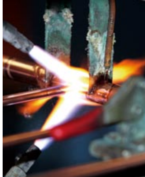
Für die Fertigung der Rohrrahmen wurde ein automatischer Lötapparat entwickelt.
