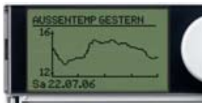
Die Bedieneinheit RC35 hat auch die Funktion einer Wetterstation.
