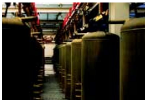
Die von der Schweißstraße kommenden Speicherkörper warten auf ihre „Weiterbehandlung“.
