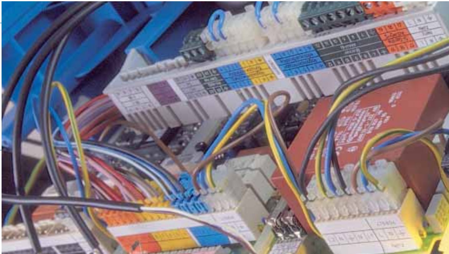
Moderne Regelungen ermöglichen eine im Vergleich zu Altkesseln kürzere Bereitschaftsdauer und helfen damit, Brennstoff einzusparen.
