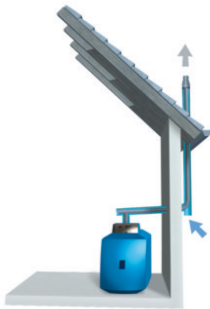
Raumluftunabhängige Aufstellvariante mit Rohr-in-Rohr-Kunststoff-Abgassystem entlang der Außenfassade
