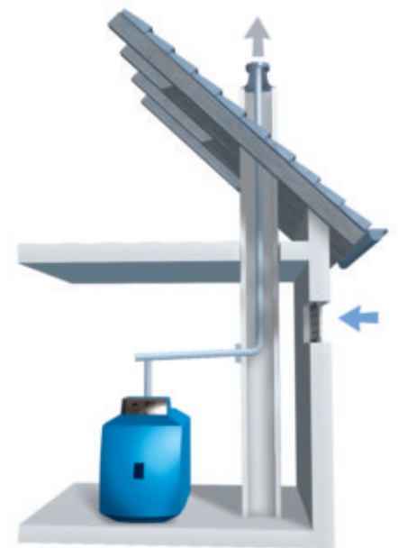
Raumluftabhängige Aufstellvariante mit eingezogenem Abgasrohr im Schornstein
