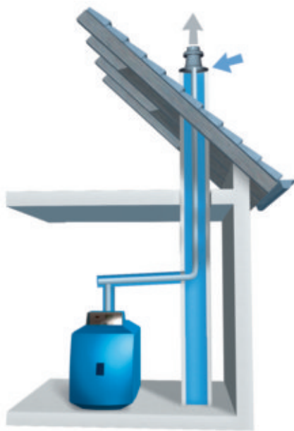
Raumluftunabhängige Aufstellvariante mit eingezogener Kunststoff-Abgasleitung im Schornstein
