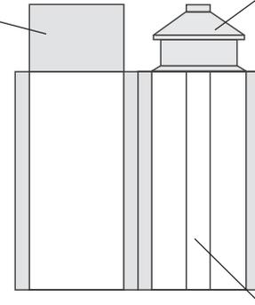
System aus Polypropylen bis 120°C, zugelassen vom Deutschen Institut für Bau-technik
