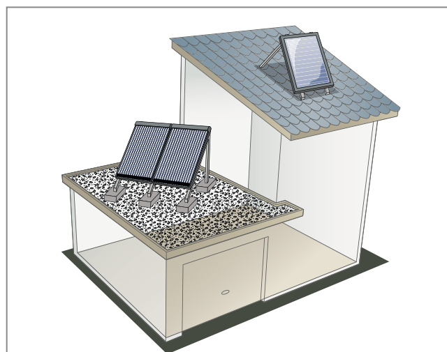
Abb 134: Freiaufstellung und aufgeständerte Aufdachmontage
