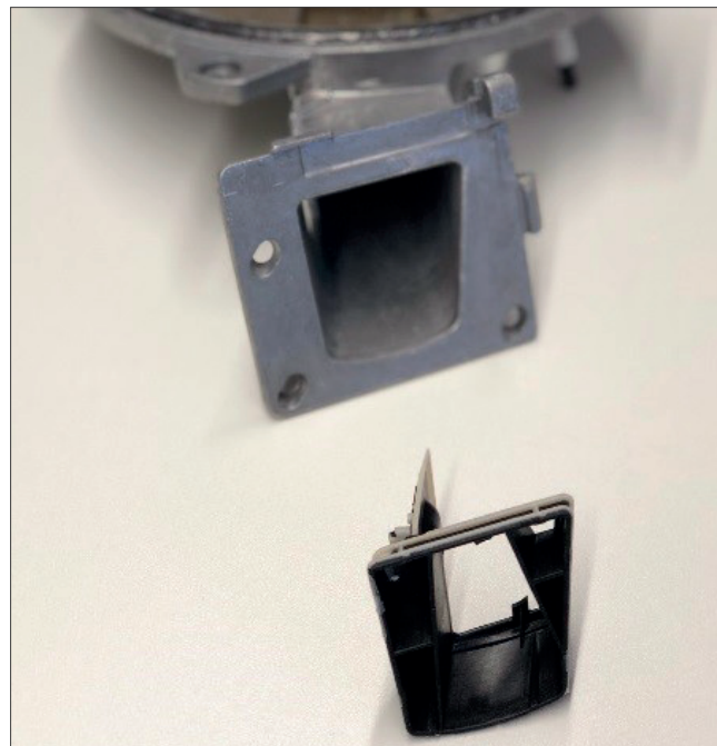
Abb 47: Installation der Rückschlagklappe
