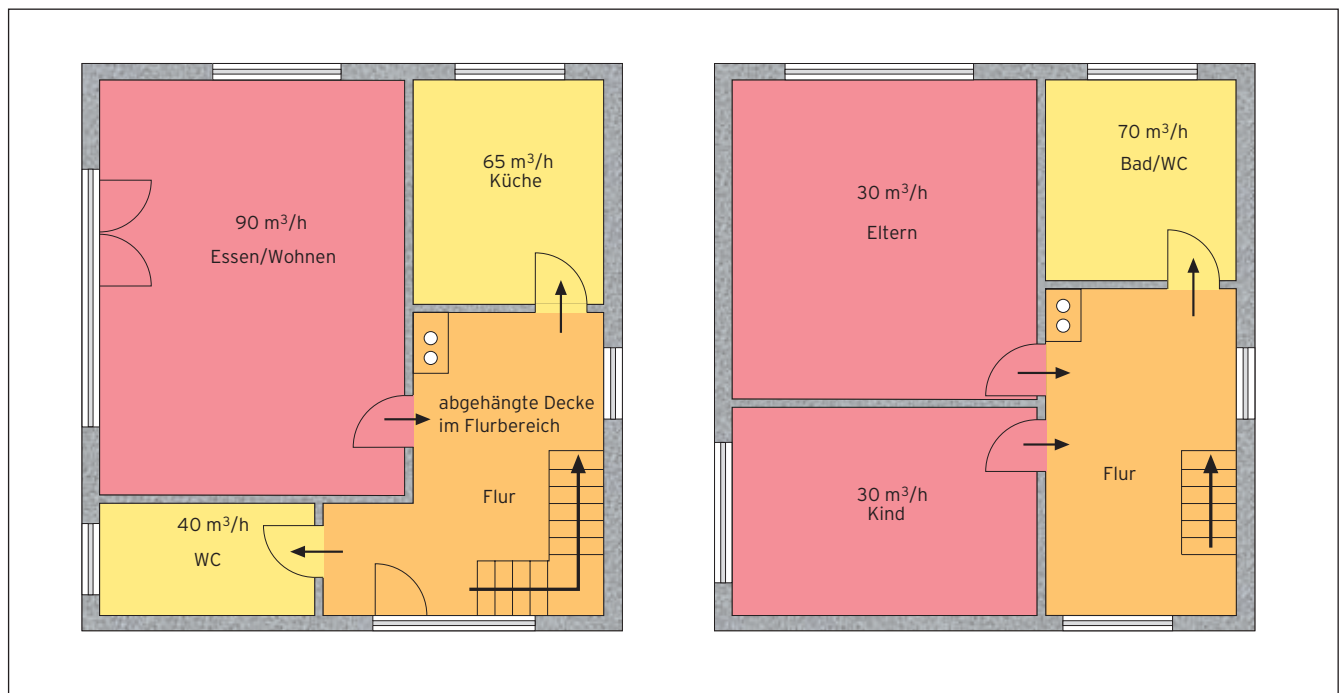
Zuluft-, Abluft- und Überströmbereiche in der Grundrissdarstellung
