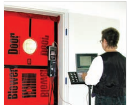
Ermittlung der Druckdifferenz (Quelle: BlowerDoor GmbH)
