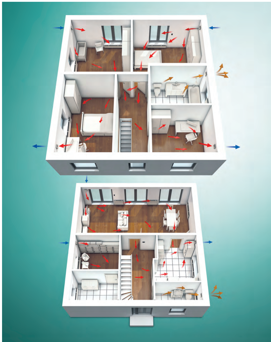
Abb 147: Dezentrale Lüftung mit Wärmerrückgewinnung in Ein- und Zweifamilienhäusern
