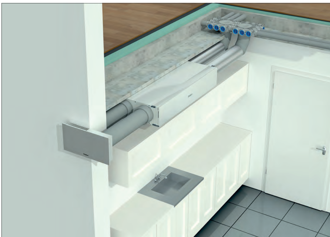
Abb 28: Installation in der Küche
