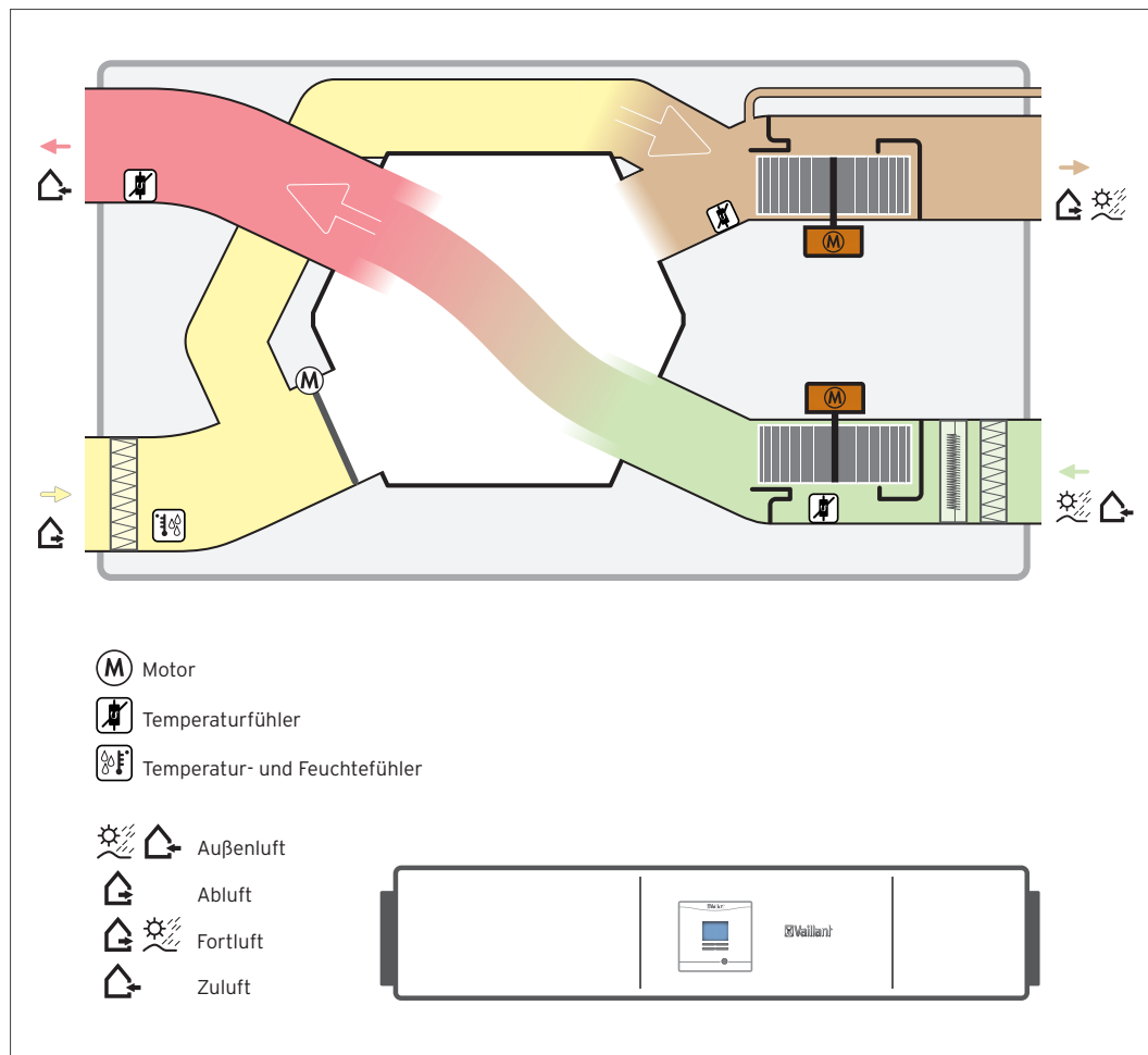
Abb 16: Funktionsschema recoVAIR /4 (Decken- und Wandgerät, Mittelstellung)
