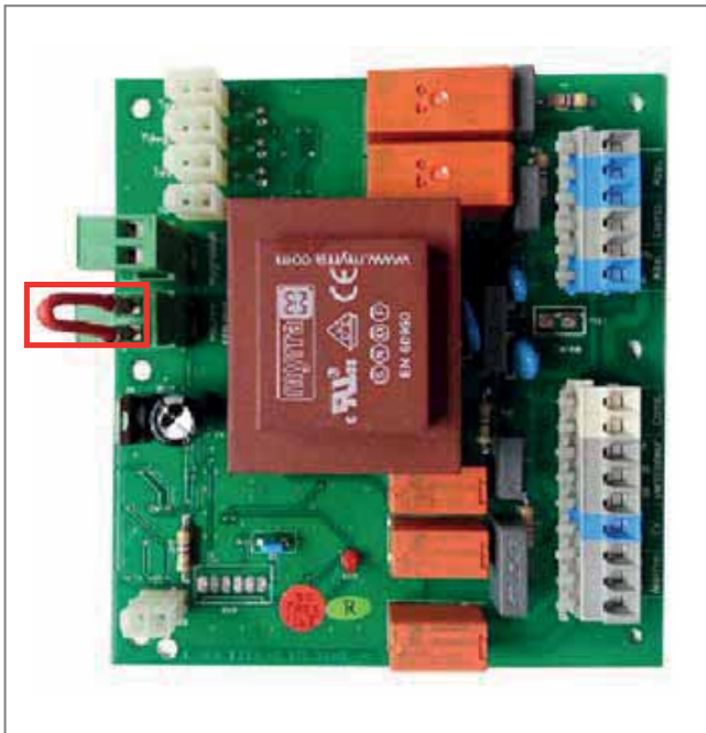
Abb. 458: Relaisplatine der aroSTOR mit Niedertarifstecker
