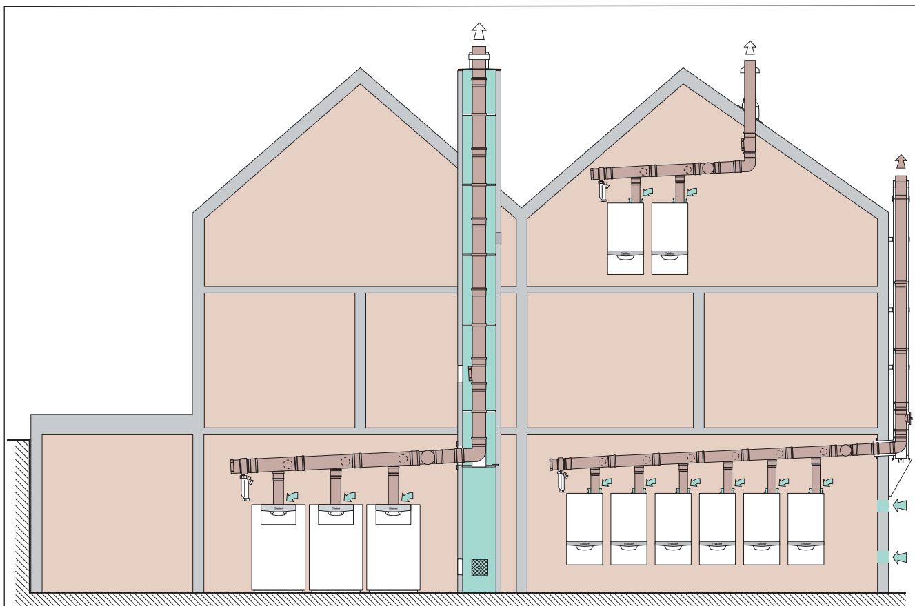
Möglichkeiten der Abgasführung für Kaskadensysteme
