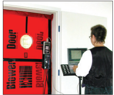
Ermittlung der Druckdifferenz (Quelle: BlowerDoor GmbH)
