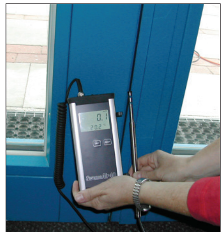
Luftgeschwindigkeitsmessgerät (Quelle: BlowerDoor GmbH)
