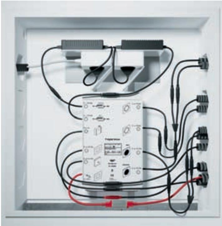
Verbindung aller einzelnen Module mit der Steuereinheit in der Konfiguration L, mit Stromversorgung (2 Netzteile mit 4 x 1-Licht-Modulen und 4 x 1 Sound-Modulen).
