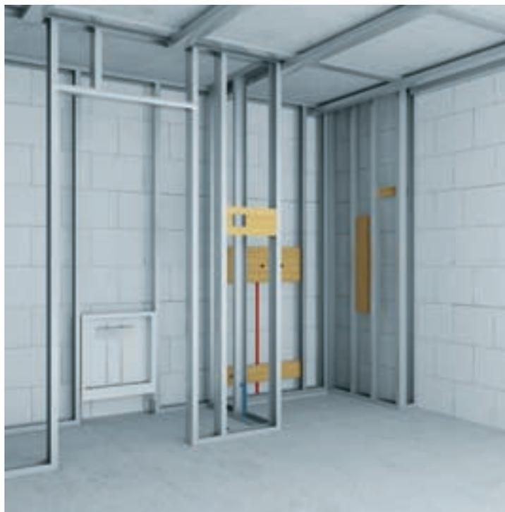
Übersicht zum Aufbau der Leichtbau-Ständerwand für die Dusche und zum Nebenraum. Befestigungsplatte für Docking-Station, Dampfauslass, Temperatursensor, Armaturen und Seitenbrausen.
