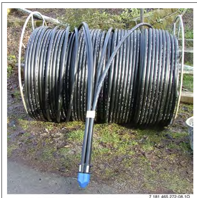
Bild 18 Erdsonde mit Sondenfuß
