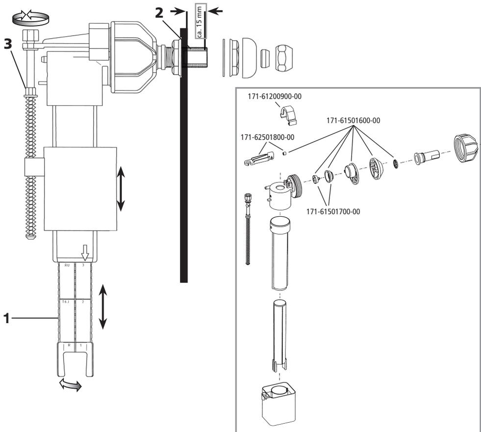
1. Das Auslaufrohr sollte entsprechend der Höhe bis zum Spülkastenboden gezogen werden. Bei Spülkästen mit extrem geringer Höhe können Sie das untere Rohr einfach weglassen. Die Verstellung erfolgt durch das untere Rohr mit einer leichten Drehbewegung.
