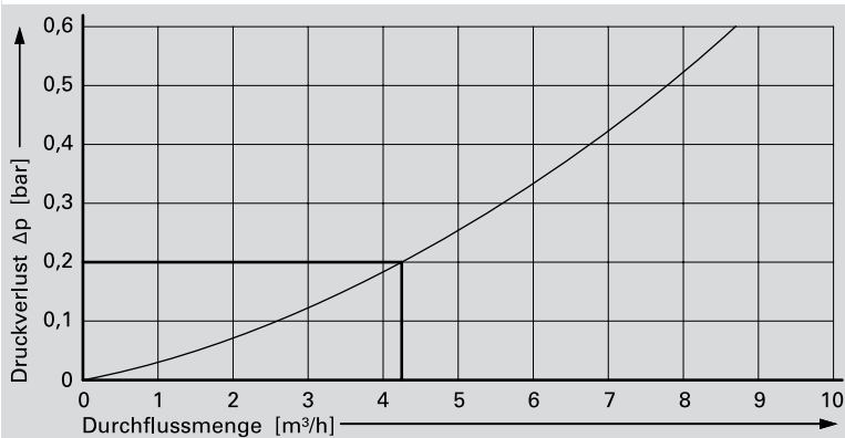
Druckverlustkennlinie der Durchströmungsarmatur R ¼
