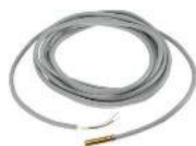
„Sensor LW TH“ Temperaturfühler, PT 1000 Heizungsanlagen -10... +105 °C
