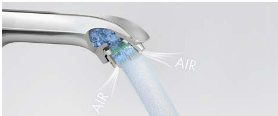
**AirPower** bewirkt, dass über den Strahlauslauf Luft angesaugt und damit das einströmende Wasser angereichert wird. Der Wasserstrahl wird fülliger, leichter und weicher.
