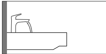
Wandhängendes Waschbecken mit darauf montierter Armatur.
