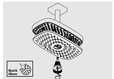
**Einfache Reinigung:** Noppen lassen sich wie gewohnt mit QuickClean-Funktion säubern. Strahlscheibe ist einfach abnehmbar und sogar für die Spülmaschine geeignet.
