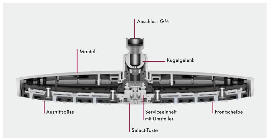
**Kopfbrausen:** Die innovative Umstelleinheit in der Kopfbrause ermöglicht die einfache Strahlumstellung nach dem Select-Prinzip. Und das rein mechanisch per Knopfdruck.
