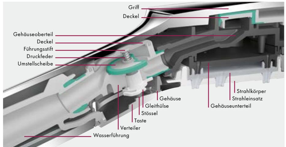
**Handbrausen:** Die revolutionäre mechanische Konstruktion erlaubt die Strahlumstellung bequem per Knopfdruck. Seine Langlebigkeit bewies der Select-Knopf im Langzeit-Belastungstest mit 90.000 Betätigungen.
