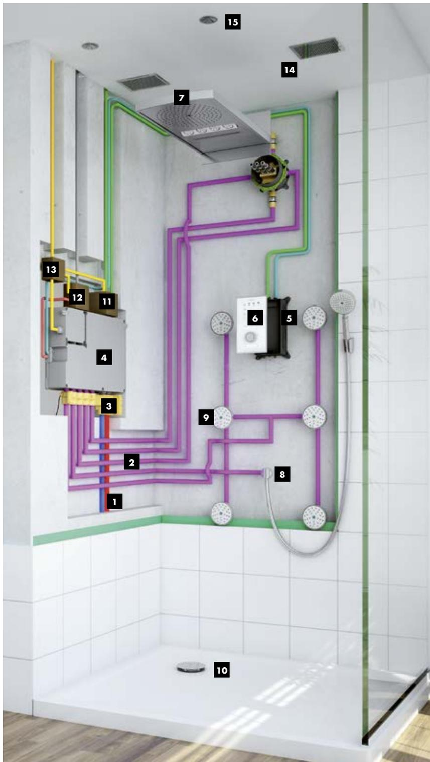
Die elektronische Duschsteuerung Hansgrohe RainBrain besteht aus insgesamt 4 Einzelkomponenten, die praxisgerecht in Grund- und Fertigset aufgeteilt sind.
