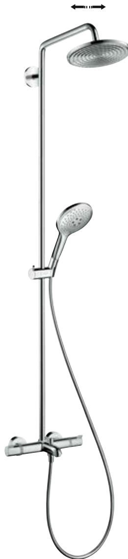
Raindance® Select 360 Showerpipe Wanne mit Raindance E 360 1jet Kopfbrause (17 l/min), Raindance Select E 120 Handbrause (15 l/min) und Ecostat Select Wanneneinlauf (20 l/min), Brausearm 380 mm # 27113, -000, -400
