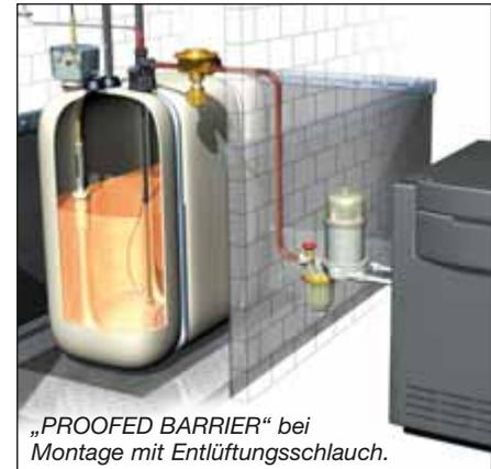
Die automatischen Heizöhlentlüfter Flow-Control 3/K-1 und 3/M eignen sich für den Einsatz in Einstrangsystemen mit Rücklaufzuführung in Ölfeuerungsanlagen zur kontinuierlichen Entlüftung.
