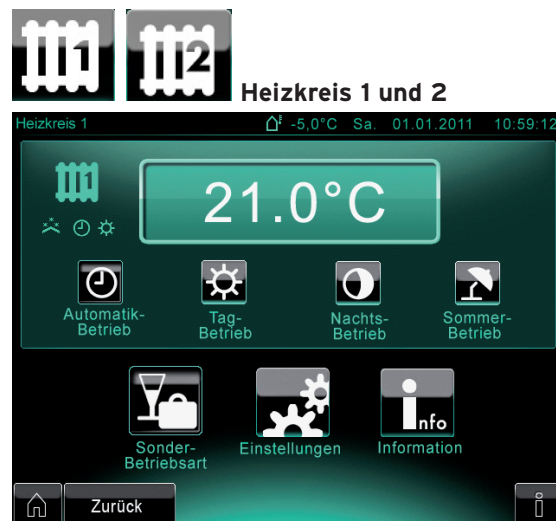
Abb. 8.4 Komponenten-Screen Heizkreis (hier: Heizkreis 1)
