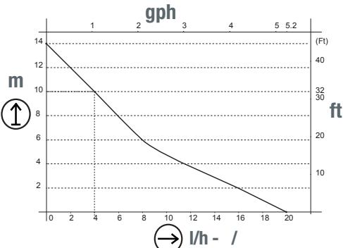
↑ Discharge / Hauteur de refoulement / Förderhöhe / Altezza di mandata / Высота нагнетания
