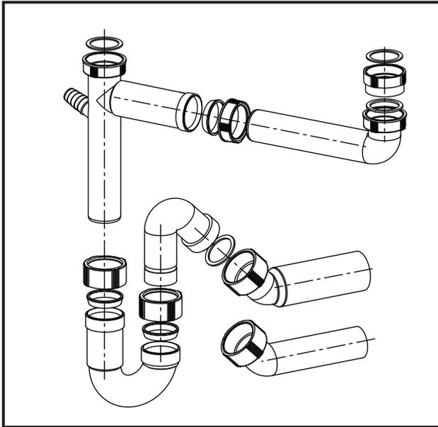
**Ablaufverbindung mit exzentrischem Abgang, Geräteanschluss und Universal-Rohrgeruchverschluss, mit Verlängerungsrohren D 40 und D 50**
