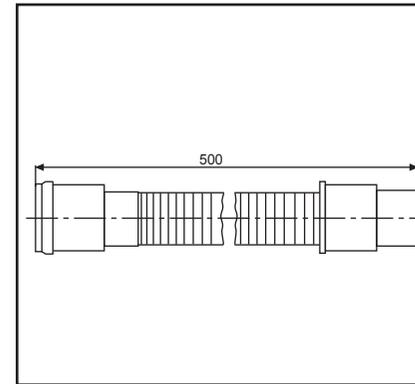
Flexibles HT-Anschlussrohr mit
