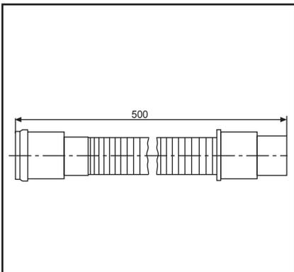
Flexibles HT-Anschlussrohr mit
