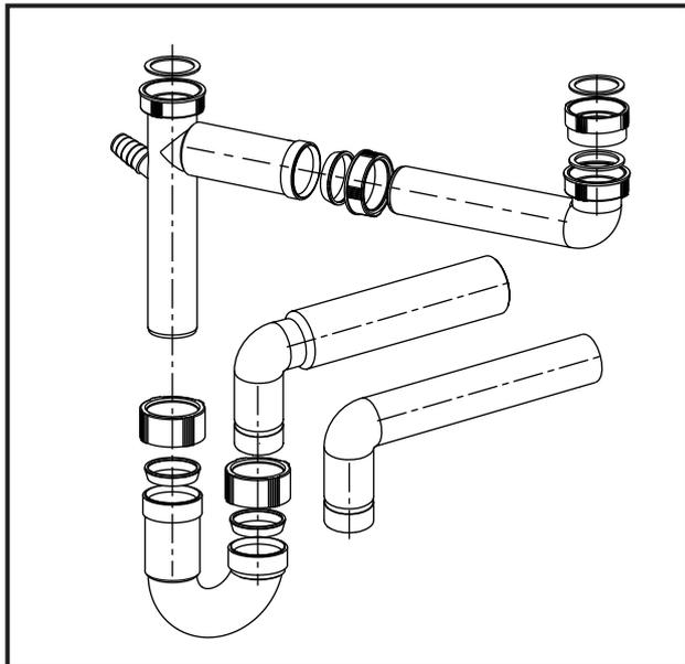
**Ablaufverbindung mit exzentrischem Abgang, Geräteanschluss und Rohrgeruchverschluss, mit Verlängerungsrohren D 40 und D 50**
