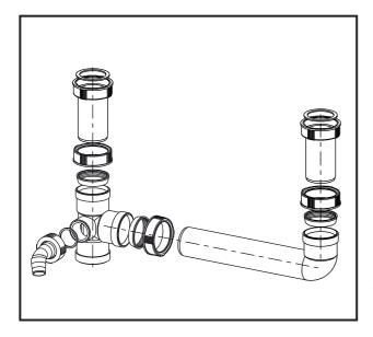
Ablaufverbindung mit exzentrischem Abgang und 2 Anschlussrohren 120 mm
