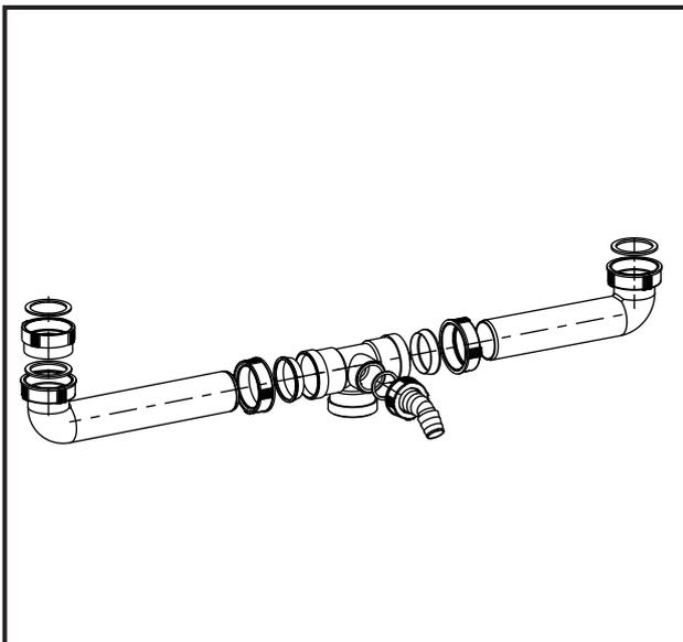
**Ablaufverbindung mit zentrischem Abgang und Höhenausgleichsstück**
