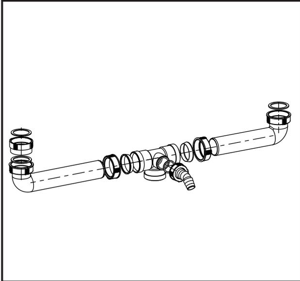
**Ablaufverbindung mit zentrischem Abgang und Höhenausgleichsstück**
