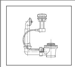
Ab- und Überlaufgarnitur drehexzenterbetätigt, mit Überlauf
