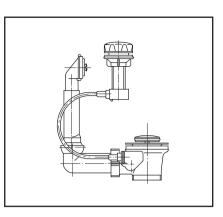
Ab- und Überlaufgarnitur drehexzenterbetätigt, mit Überlauf
