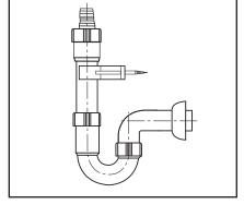
Rohrgeruchverschluss mit Tülle und Gummimanschette
