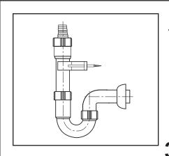
Rohrgeruchverschluss mit Tülle und Gummimanschette
