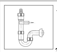
Rohrgeruchverschluss mit Tülle und Gummimanschette
