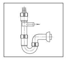
Rohrgeruchverschluss mit Tülle und Gummimanschette
