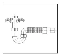
Rohrgeruchverschluss mit flexiblen Schlauch (gesteckt) mit 2 Geräteanschlüssen 1"
