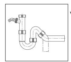
Universal-Rohrgeruchverschluss mit Geräteanschluss
