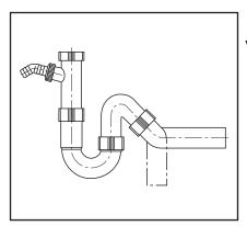
Universal-Rohrgeruchverschluss mit Geräteanschluss
