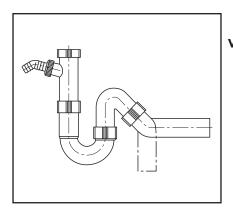
Universal-Rohrgeruchverschluss mit Geräteanschluss
