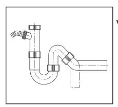
Universal-Rohrgeruchverschluss mit Geräteanschluss
