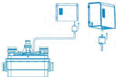
6.1. تشغيل لوحة مفاتيح التحكم **SANICUBIC® 1**
