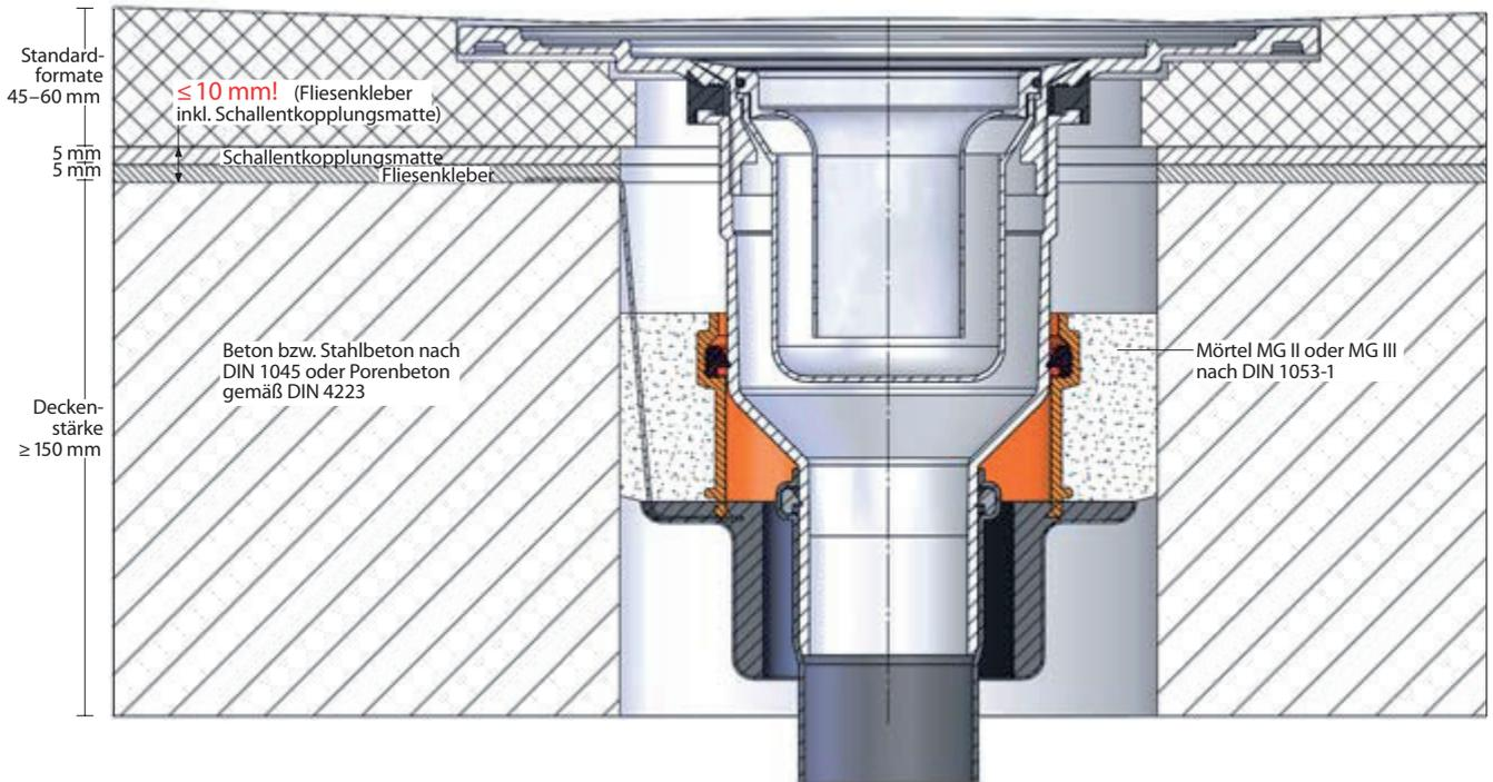
Einsatzbereich 2: nur ab einer Mindestaufbauhöhe von 70 mm unter dem Duschelement!
