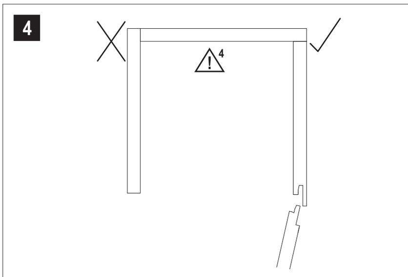
**!** 4 Die Zuschnitte der Wandverkleidungen sind hinsichtlich Nut und Feder so zu wählen, das bei Plattenverbindungen immer die Feder in die Nut eingesetzt wird. Stumpfe Plattenstöße im Eckbereich sind so zu setzen das sie bei Betreten nicht sichtbar angeordnet sind (Siehe Bild).
