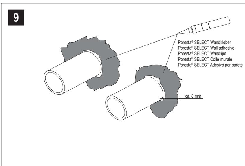
**!** 10 In den Wandbereichen, in denen Anschlüsse für Armaturen o.ä. durchgeführt werden, muss kreisförmig abgedichtet und die Auftragsmenge erhöht werden, damit in diesen Bereichen kein Hohlraum zwischen Wandverkleidung und Wanduntergrund entsteht. Dübel sind grundsätzlich nicht in dem Poresta® SELECT Wandelement, sondern im Untergrund aufzuspreizen.
