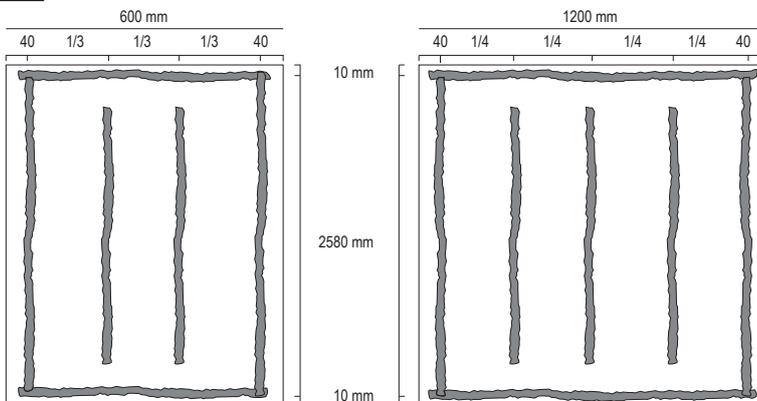
⚠ 11 Es ist zu empfehlen umlaufend einen Rahmen aus Poresta® SELECT Wandkleber aufzutragen. Dies dient als Wassersperre gegen das Eindringen von aufsteigender Feuchtigkeit hinter den Poresta® SELECT Wandelementen.
