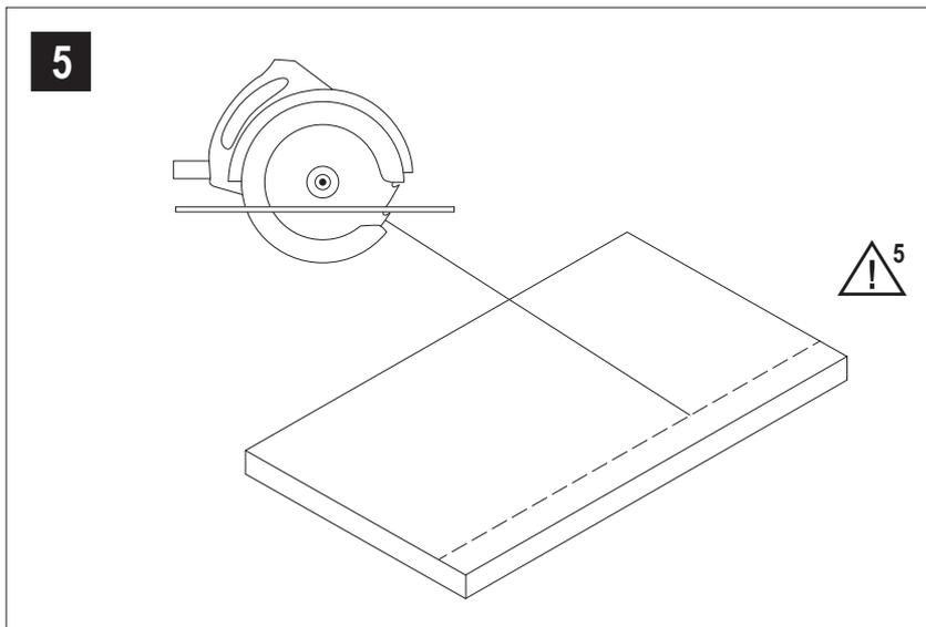
**!** 5 Beim Zuschnitt von Poresta® SELECT Wandelementen mit der Handkreis- oder Tauchsäge wird die Verwendung einer Führungsschiene oder einer Anschlagleiste empfohlen. Der Zuschnitt sollte von der Plattenvorderseite erfolgen, um Ausrisse zu vermeiden. (Bild 3 bis 5)
