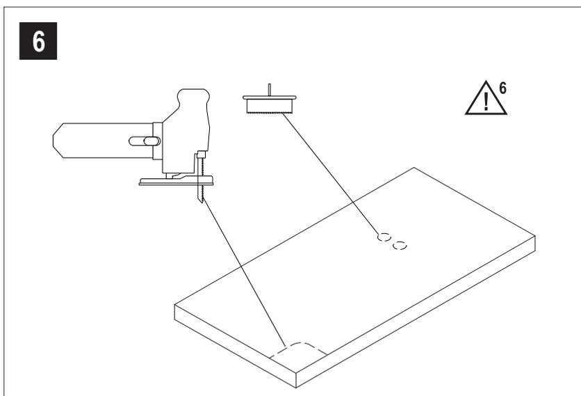
**!** 6 Form- bzw. Konturenschnitte o.ä. werden mit der Stichsäge ausgeführt. Die Schnittkantenqualität ist im Besonderen von der Wahl des Sägeblattes abhängig. Es wird empfohlen Sägeblätter einzusetzen, die sich für den Zuschnitt von HPL Platten eignen.
