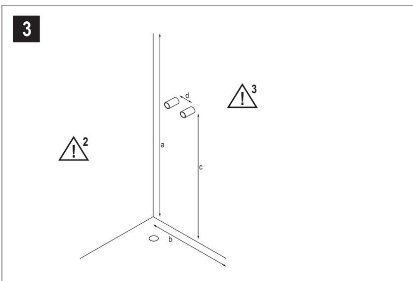
**3** In Abhängigkeit von der Einbausituation werden die Poresta® SELECT Wandelemente ausgemessen. Dabei muss beachtet werden, dass die Wandverkleidungen später passgenau eingebaut werden müssen. Die Wandverkleidungen sind mit einem Abstand von 3 mm (Bewegungs- / Dehnungsfuge) zu allen angrenzenden senkrechten Bauteilen, und mit einem Abstand von 5 mm zum Boden zu montieren.
