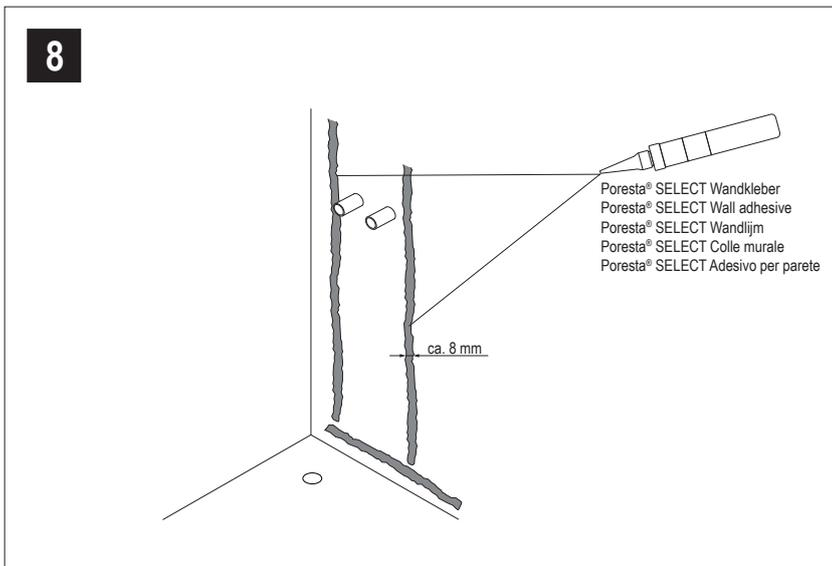
**!** 9 Der Poresta® SELECT Wandkleber wird streifenweise mit einem maximalen Abstand von 250 mm zwischen den Klebstoffraupen aufgetragen. Der Poresta® SELECT Wandkleber kann auf dem Poresta® SELECT Wandelement oder auf der Wand aufgetragen werden.
