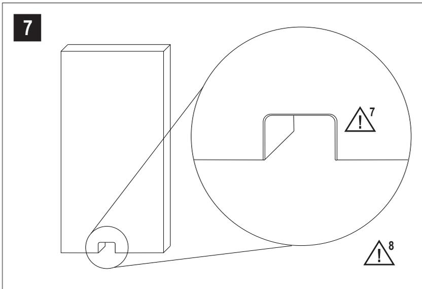
**!** 7 Bei Ausschnitten und Innenaussparungen von Wandverkleidungen sind die Ecken stets abzurunden (siehe Abbildung). Der Innenradius soll möglichst groß ausgeführt werden. Bei Ausschnitten mit einer Größe von bis zu 250 mm Seitenlänge müssen diese Ecken einen Mindestradius von 5 mm haben. Bei größeren Abmessungen muss dieser entsprechend der Seitenlängen proportional vergrößert werden.
