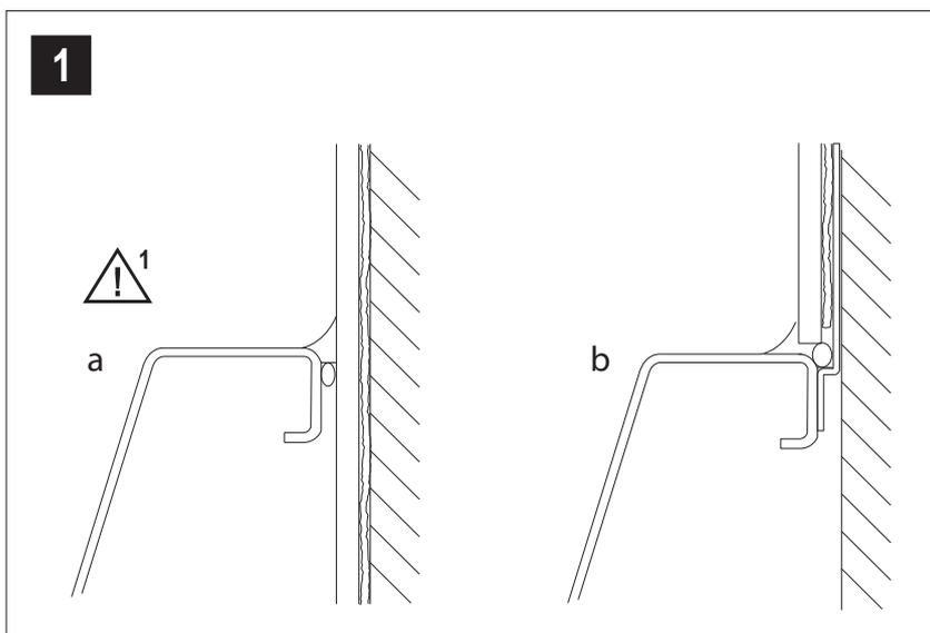
**1** Poresta® SELECT Wandelement wird hinter der Wanne herunter geführt (a). Dabei ist auf eine durchlaufende Dichtebene an der Wand und unterhalb des Duschplatzes gemäß DIN 18534 zu achten.
