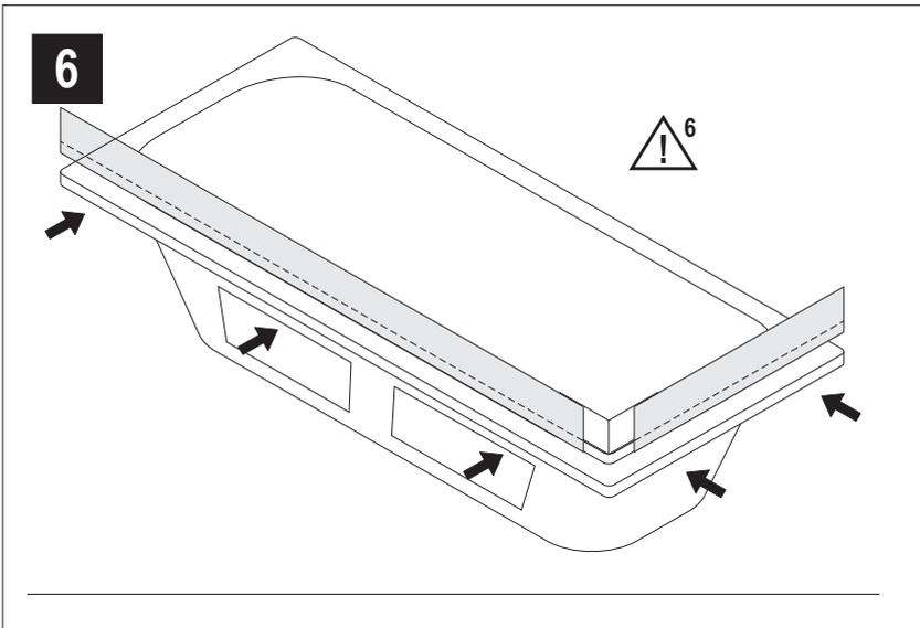
**!** 6 Zubehör: 3D Wannenrand Dichtset gemäß Einbauanleitung poresta systems GmbH montieren
