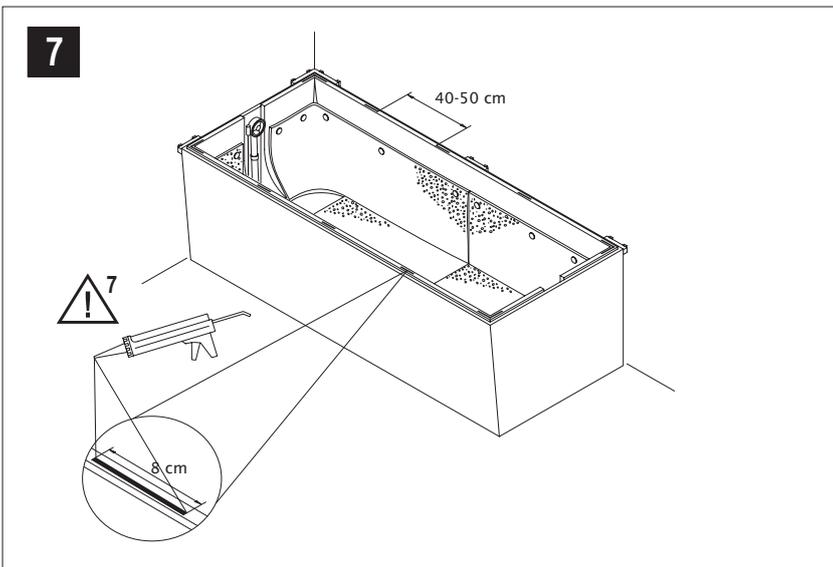
**!** 7 Poresta® STP Konstruktionskleber auf die geraden Seiten und Ecken des Wannenträgers auftragen. Auftragslänge ca. 8cm, Abstand zu dem nächsten Auftrag 40-50 cm.
