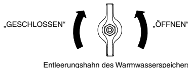
Entleerungshahn des Warmwasserspeichers (a)
