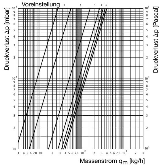
**Druckverlustdiagramm wie oben, AV6-Einsatz bei 1 K P-Abweichung**
