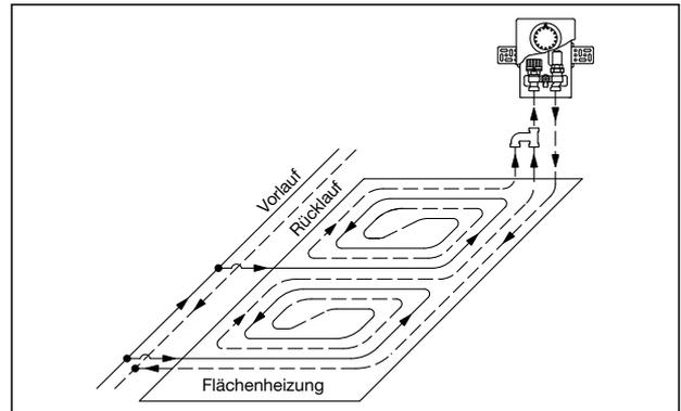
Einbauskizze „Unibox“, mit zwei gleich langen Heizkreisen
