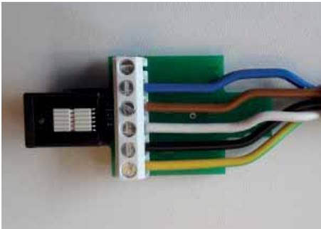
Abb. 4.14 vorhandene NYM-Leitung, an Adapter-Klemme angeschlossen
