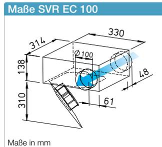
**Energiesparende EC-Rohrventilatoren zur Förderung mittlerer und kleinerer Luftvolumen gegen hohe Widerstände.**
