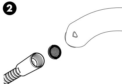
Mit Rubit®, der manuellen Reinigungsfunktion können die Strahlformer durch einfaches rubbeln vom Kalk befreit werden.
