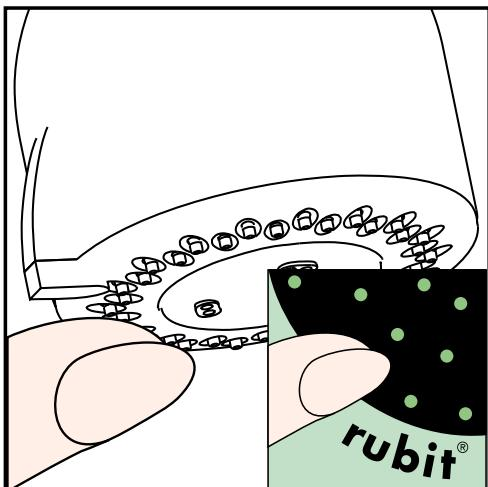
Med rubit, den manuelle rengøringsfunktion kan strålekanalerne let renses for kalk - der skal blot gnubbes!
