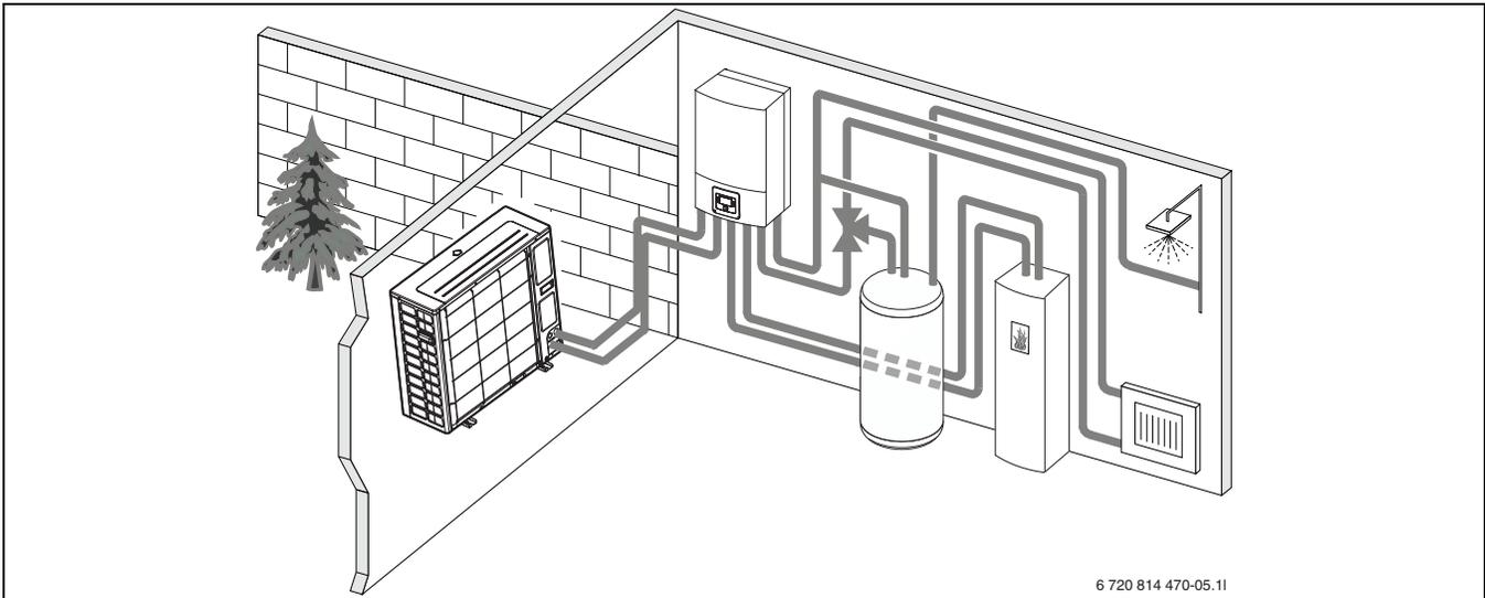
Bild 3 Wärmepumpe Ausseneinheit, Inneneinheit ASB ohne elektrischen Zuheizler, externer Warmwasserspeicher und externer Zuheizler
