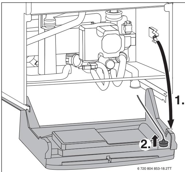
Bild 67 Steuergerät nach unten klappen
