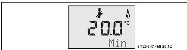
Bild 39 **Min** (= minimale Nennwärmeleistung) blinkt
