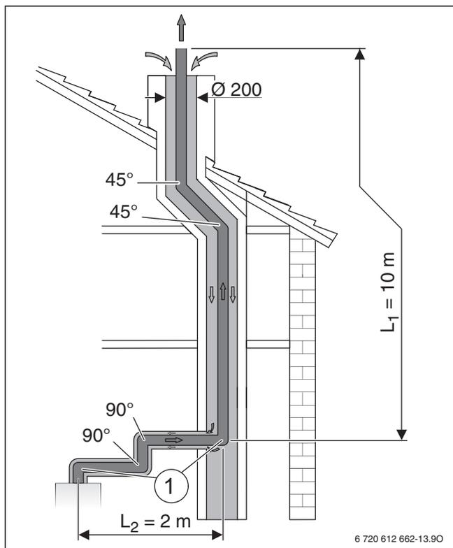
Bild 15 Einbausituation einer Abgasführung nach C<sub>93x</sub>
