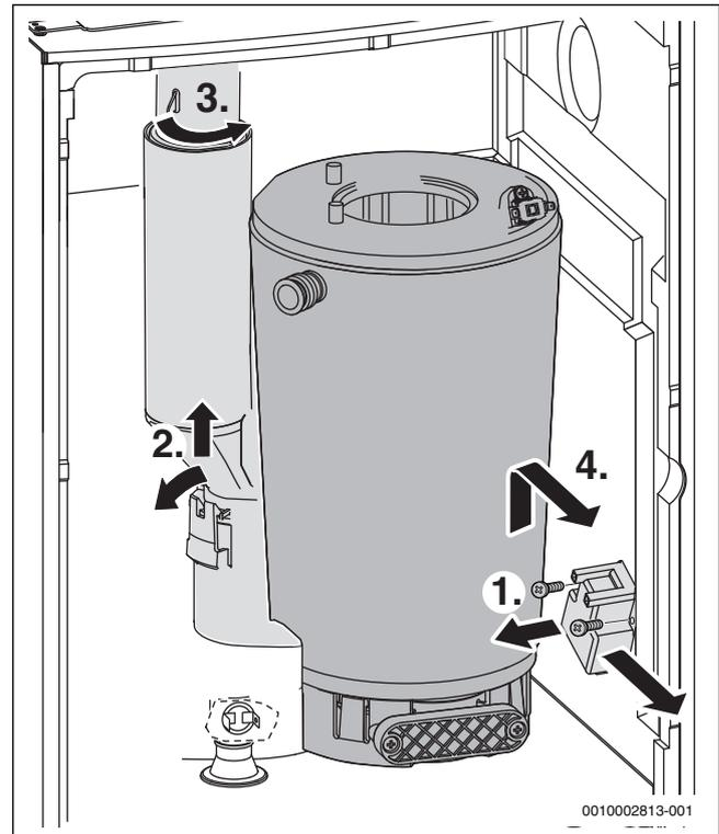
Bild 72 Wärmeblock ausbauen
