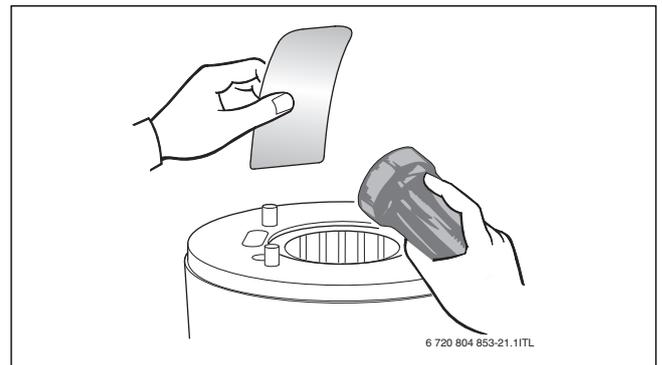
Bild 52 Wärmeblock auf Rückstände prüfen
