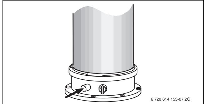
Bild 36 Abgasmessstutzen
