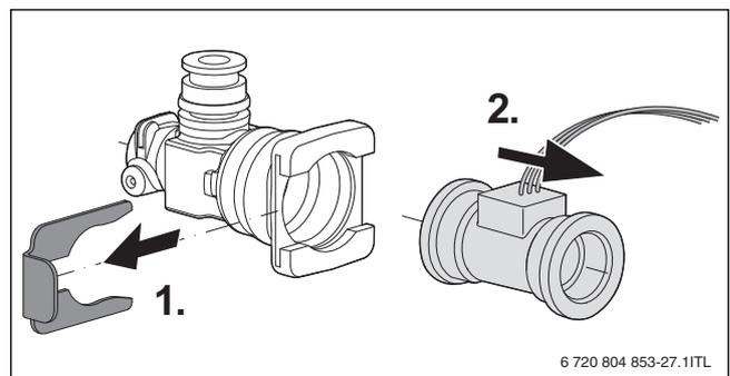
Bild 57 Turbine am Kaltwasserrohr ausbauen
