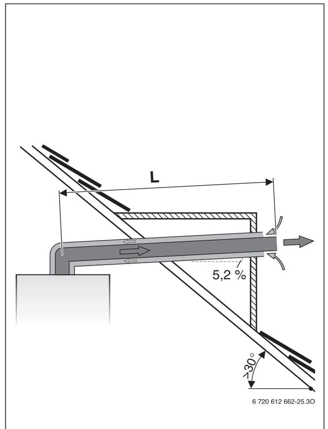
Bild 12 Abgasführung waagrecht nach C<sub>13x</sub>
