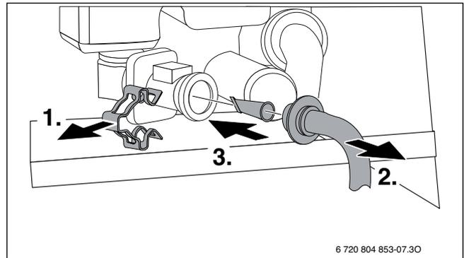
Bild 56 Sieb aus Kaltwasserrohr ausbauen
