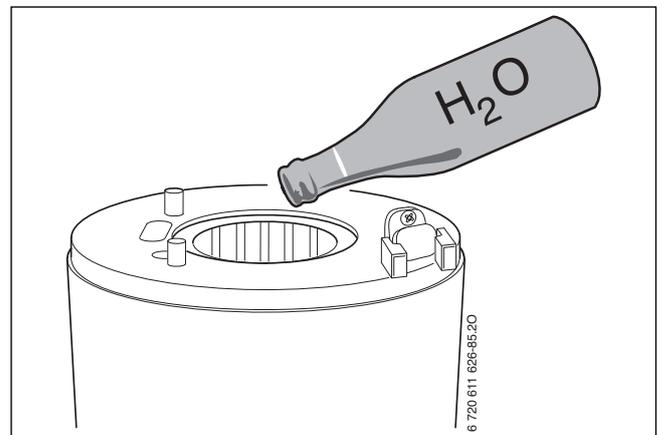
Bild 53 Wärmeblock mit Wasser spülen
