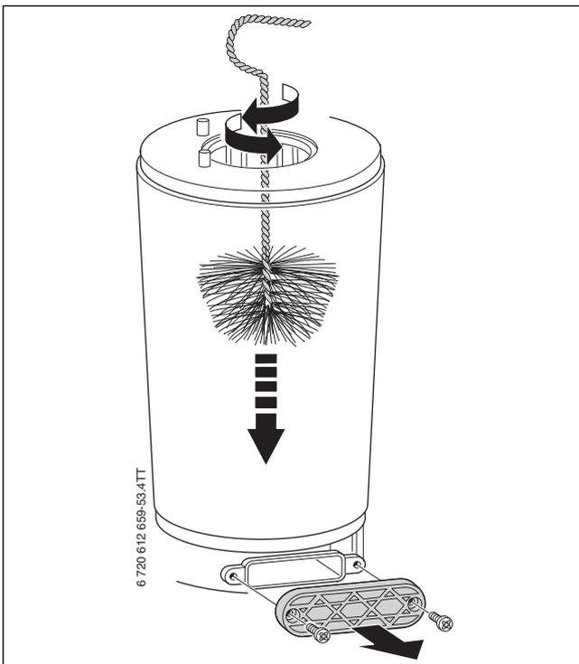
Bild 51 Wärmeblock reinigen
