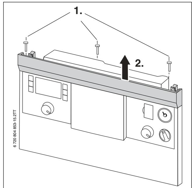
Bild 25 Abdeckung entfernen
