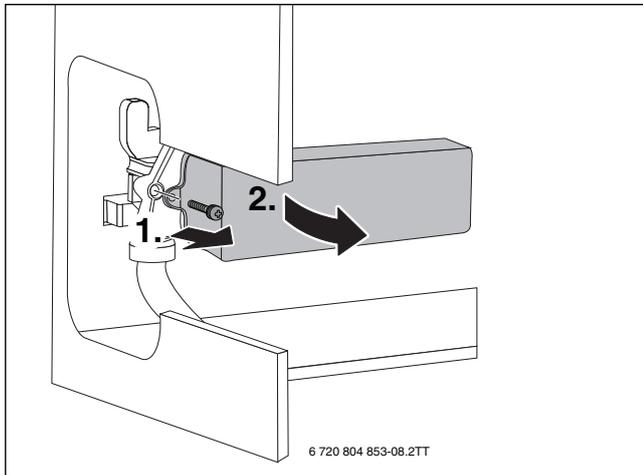
Bild 58 Plattenwärmetauscher ausbauen
