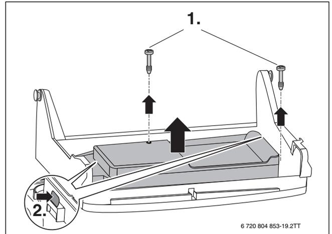
Bild 68 Abdeckung entfernen
