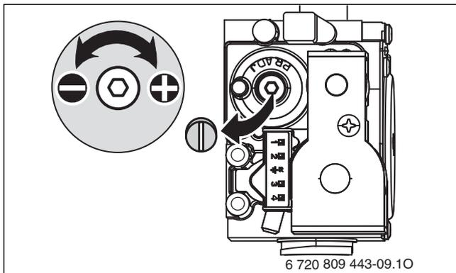
Bild 40 Plombe an der Gasarmatur entfernen
