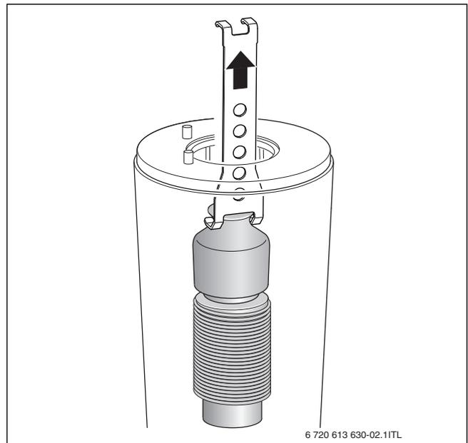
Bild 49 Oberen Verdrängungskörper herausnehmen
