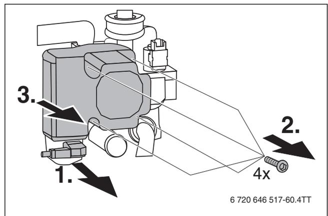
Bild 65 Heizungspumpe ausbauen
