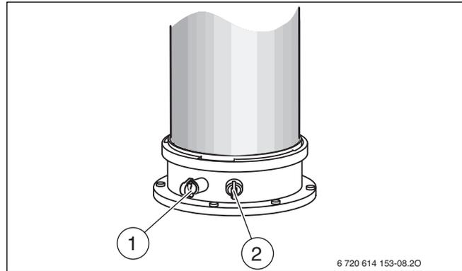
Bild 44 Abgasmessstutzen und Verbrennungsluft-Messstutzen
