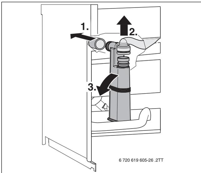
Bild 54 Kondensatsiphon ausbauen
