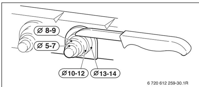
Bild 28 Zugentlastung an Kabeldurchmesser anpassen
