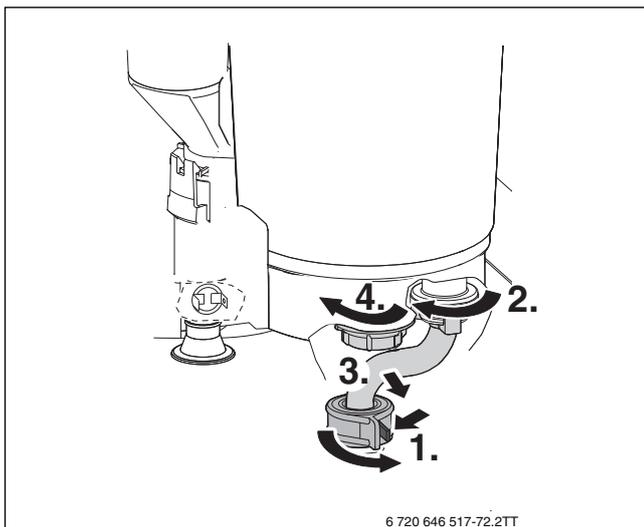
Bild 71 Mutter entfernen und Rücklaufrohr lösen
