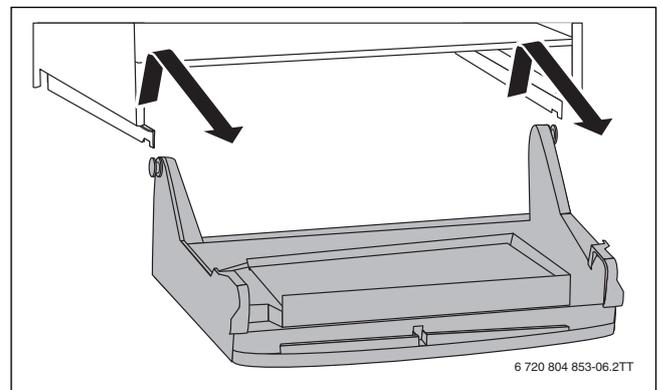
Bild 69 Steuergerät aushängen
