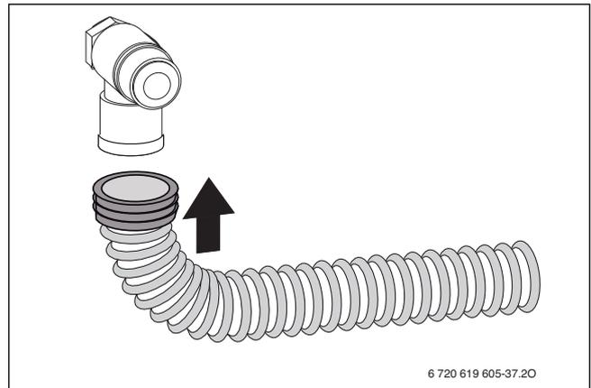
Bild 20 Schlauch am Sicherheitsventil montieren
