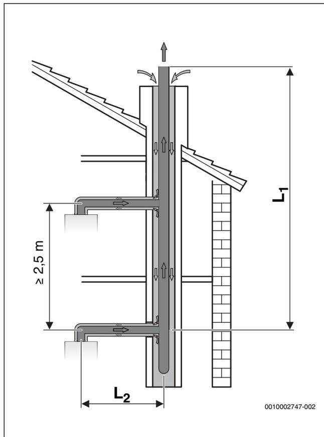
Bild 16 Mehrfachbelegung mit konzentrischem Rohr nach C<sub>43x</sub>
