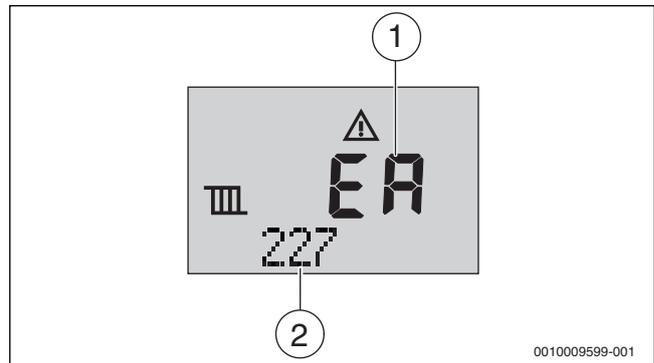
Bild 74 Beispiel: Anzeige einer verriegelnden Störung
