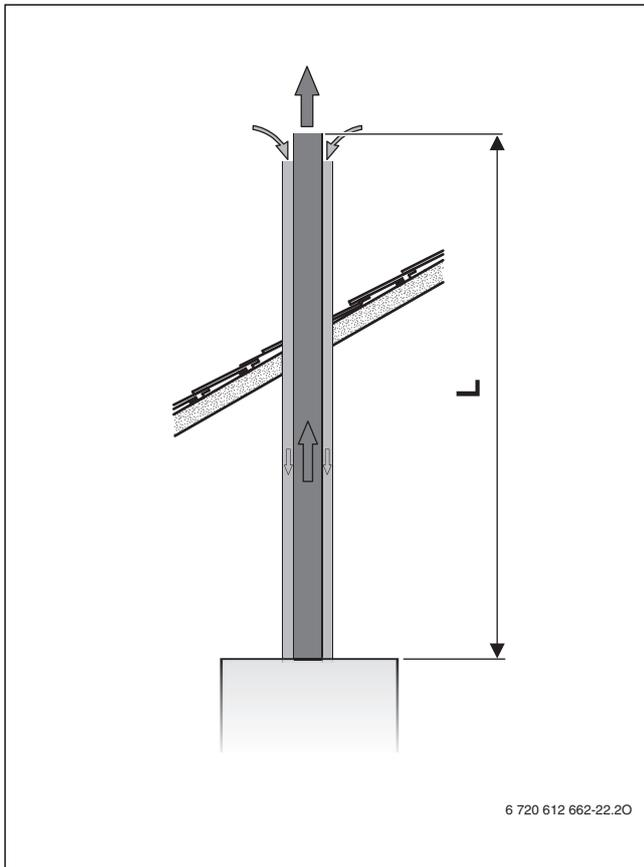
Bild 13 Abgasführung senkrecht nach C<sub>33x</sub>
