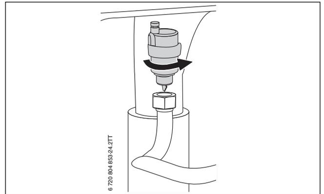
Bild 59 Automatischen Entlüfter ausbauen
