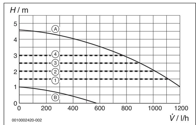
Bild 76 Pumpenkennfelder und Pumpenkennlinien
