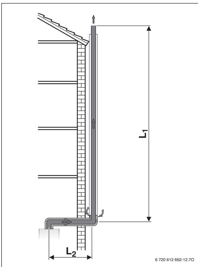
Bild 14 Abgasführung an der Fassade nach C<sub>53x</sub>
