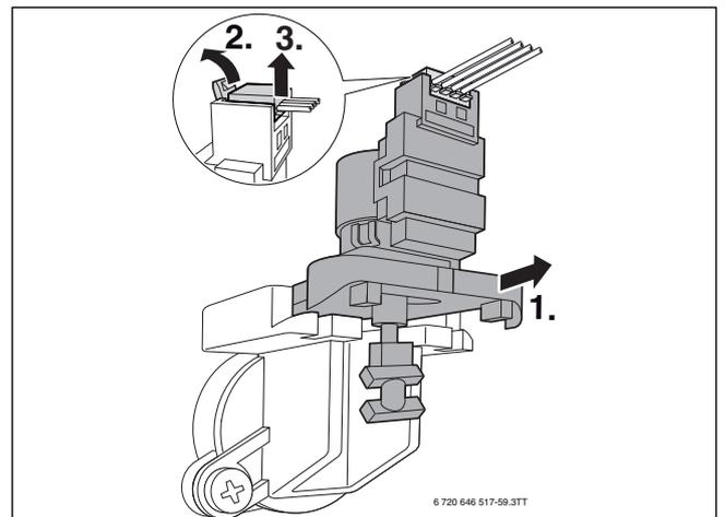
Bild 60 Motor des 3-Wege-Ventils ausbauen
