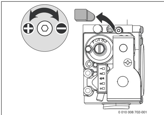
Bild 38 Plombe entfernen
