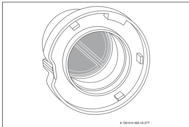
Bild 55 Membran in der Mischeinrichtung
