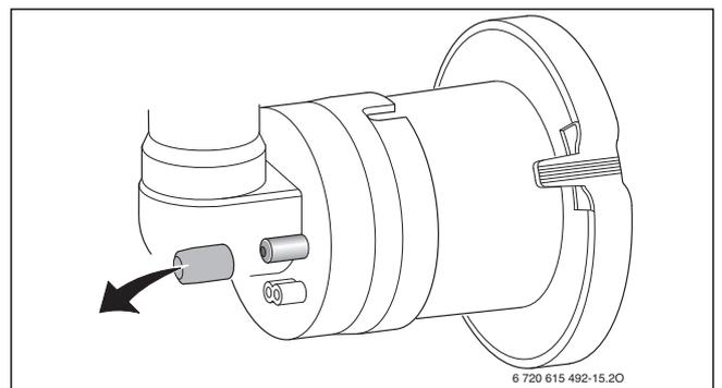
Bild 45 Messstutzen an der Mischeinrichtung
