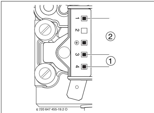
Bild 62 Messstellen an der Gasarmatur
