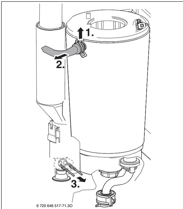
Bild 70 Vorlaufrohr lösen und Kabel abziehen
