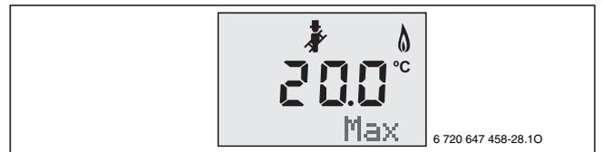
Bild 42 **Max** (= maximale Nennwärmeleistung) blinkt
