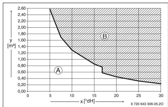
Bild 17 Anforderungen an Füll- und Ergänzungswasser Geräte < 50 kW
