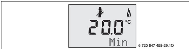
Bild 34 **Min** (= minimale Nennwärmeleistung) blinkt
