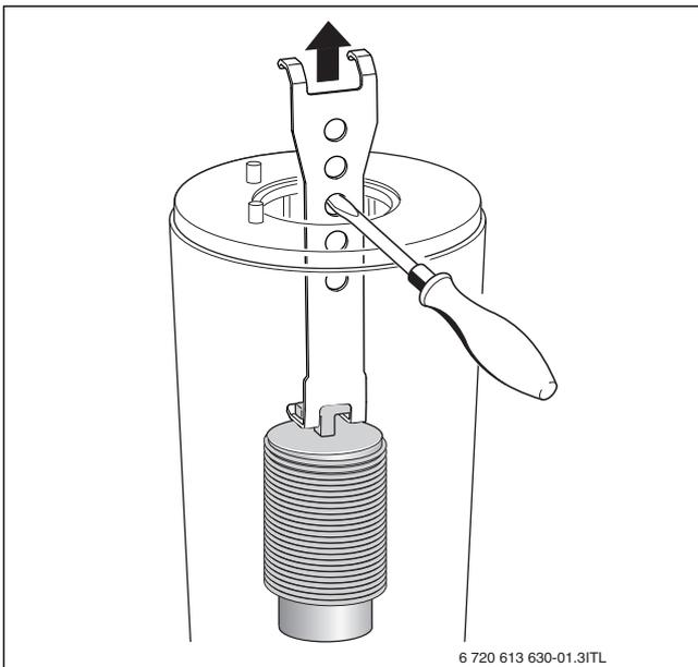
Bild 50 Unteren Verdrängungskörper herausnehmen
