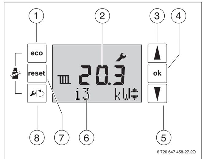
Bild 31 Übersicht der Bedienelemente
