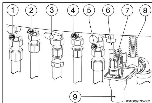
Bild 23 Gas- und wasserseitige Anschlüsse (Zubehör)
