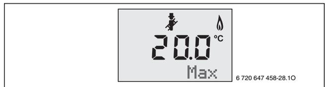
Bild 37 **Max** (= maximale Nennwärmeleistung) blinkt
