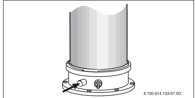
Bild 32 Abgasmessstutzen
