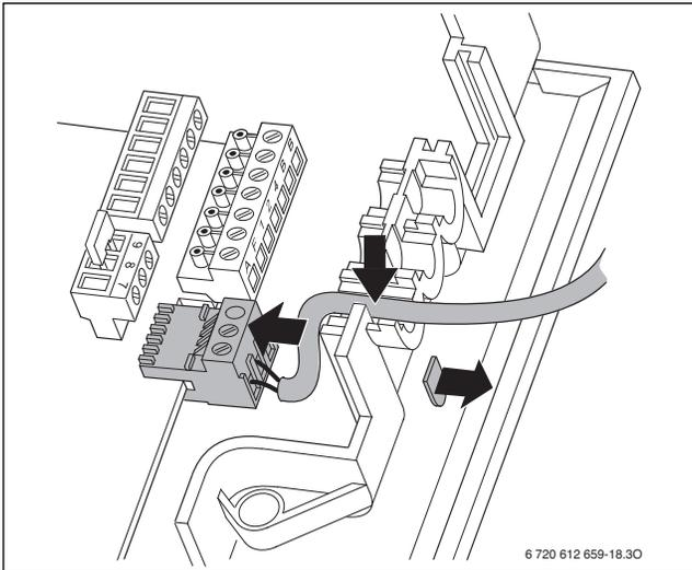
Bild 23 Anschluss Speichertemperaturfühler
