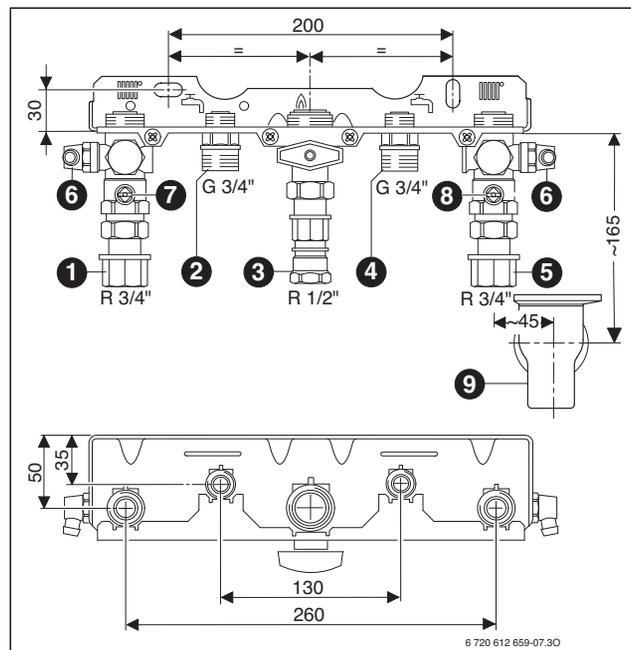
Bild 9 Beispiel: Montageanschlussplatte Nr. 993 Speicheranschluss Aufputz
