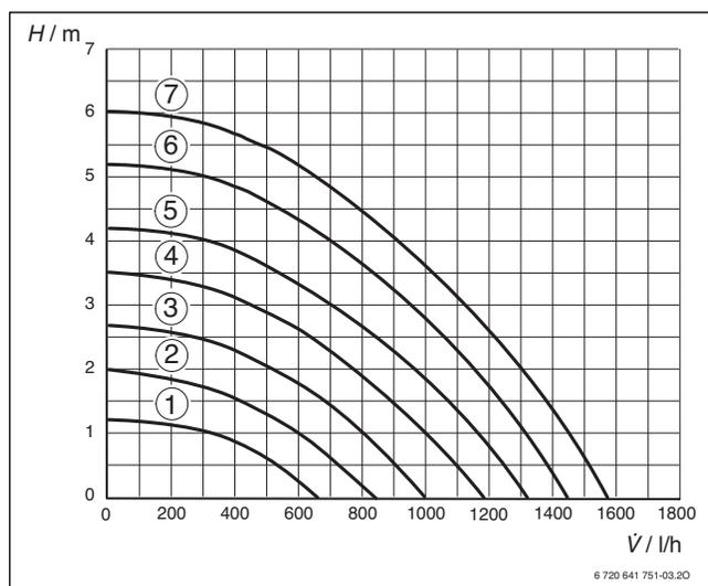
Bild 44 Pumpenkennlinien
