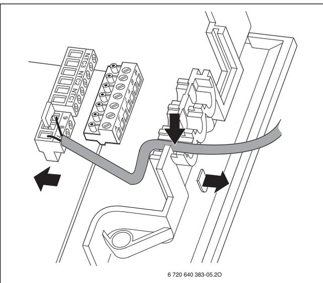
Bild 24 Anschluss Speicherthermostat
