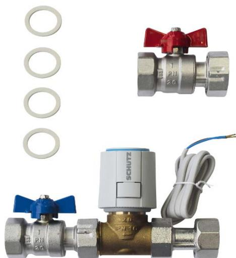
Montage des Kugelhahns erfolgt am Vorlauf des Heizkreisverteilers. Das Zonenventil (bestehend aus Zweiwegeventil, Kupplung, Kugelhahn und Stellantrieb) wird am Rücklauf angebracht. Der Durchfluss kann anhand von sechs  $k_{vs}$ -Werten am Zonenventil voreingestellt werden:
